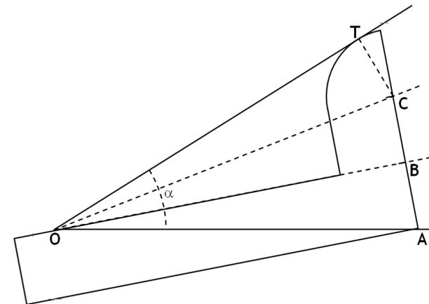
El aparato se desplaza y gira sobre el ángulo de tal manera que quede con el vértice del ángulo en un punto de la parte superior del "mango" y, al mismo tiempo, A debe quedar situado en un lado del ángulo, siendo el otro lado tangente interior al arco DE. Los tres triángulos OAB, OBC Y OCT son rectángulos y tienen la misma hipotenusa y el cateto menor, luego los ángulos son iguales a la tercera parte de  $\alpha$ .
