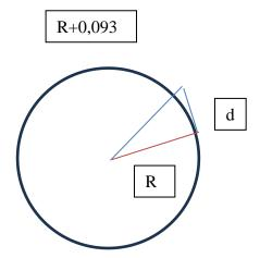
Se forma un triángulo rectángulo entre el radio de la Tierra, el radio de la Tierra más la antorcha de la estatua de la libertad y la distancia:
