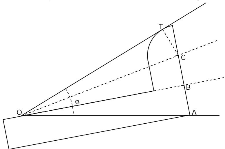
El aparato se desplaza y gira sobre el ángulo de tal manera que quede con el vértice del ángulo en un punto de la parte superior del "mango" y, al mismo tiempo, A debe quedar situado en un lado del ángulo, siendo el otro lado tangente interior al arco DE. Los tres triángulos OAB, OBC Y OCT son rectángulos y tienen la misma hipotenusa y el cateto menor, luego los ángulos son iguales a la tercera parte de  $\alpha$ .
