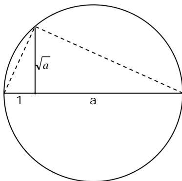
Dibujamos un segmento horizontal de longitud  $1+a$  y trazamos la circunferencia cuyo diámetro es dicho segmento. Por el punto que dista  $1$  desde uno de los extremos se levanta la perpendicular hasta encontrar la circunferencia.
