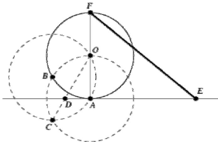
donde  $O_A(0,0)$ ,  $O(0,1)$  y  $F(0,2)$ . Los círculos  $C_1$ ,  $C_2$  centrados en  $O$  y  $A$  se cortan en  $B$ . Sea  $C_3$  el círculo de centro  $B$  y radio 1,  $C$  la intersección de  $C_2$ ,  $C_3$ , y  $D$  el punto de corte de  $CO$  con el eje  $x$ . Finalmente se construye  $E$  de tal manera que  $DE=3$ , entonces  $EF$  es,
